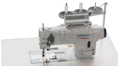
Rajout d'une deuxième aiguille pour renforcer la couture. Parfaitement adaptée et recommandée pour la couture de drapeaux, oriflammes... Gain de temps et robustesse des coutures assurés.
