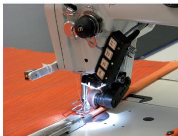
Éclairage des points de couture à l'aide de lampes LED incorporées pour un meilleur confort de travail & système de refroidissement des aiguilles permettant une augmentation de leur durée de vie.
