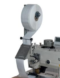
Outil guide tenseur pour l'enroulement et le défilement des rubans.
