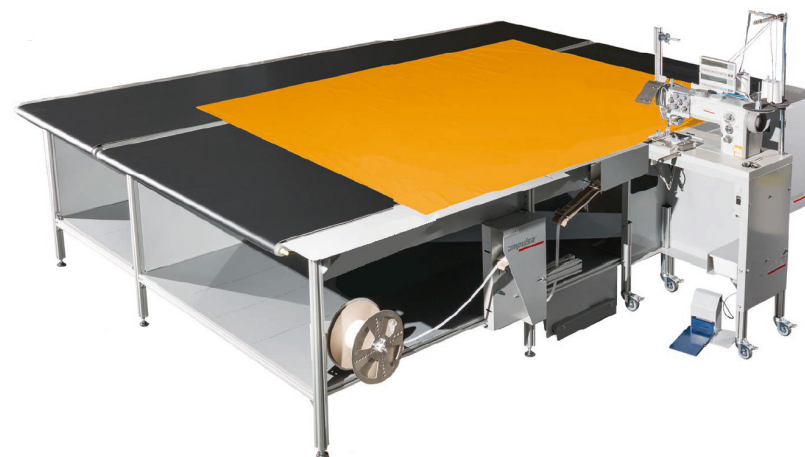
Agrandissement de la zone de travail grâce aux tables de convoyage synchronisées
