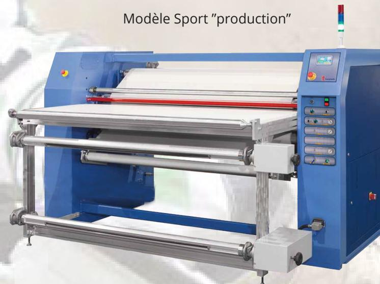
Les calandres SPORT dispose de 3 moyens de production différents, ce qui en fait des machines particulièrement complètes et appréciées des utilisateurs. Un mode feuille à feuille du papier transfert placée sur la table de convoyage au contact direct du tissu pré-découpé. L'utilisation de papier transfert en rouleaux avec la possibilité de placer des morceaux de tissus pré-découpés. L'impression traditionnelle en Roll to Roll.
